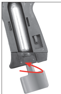
Girar hacia arriba el tornillo perforador y perfore la cápsula.
