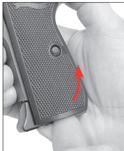
Щёчку рукоятки снять.
